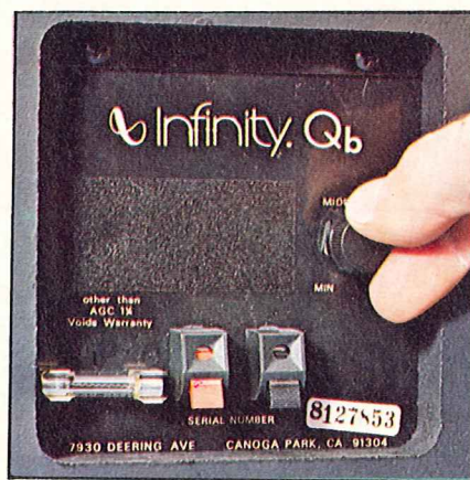
Nell'incavo dei collegamenti, ci sono oltre ai due morsetti a pressione, un controllo di livello e un fusibile di protezione.
